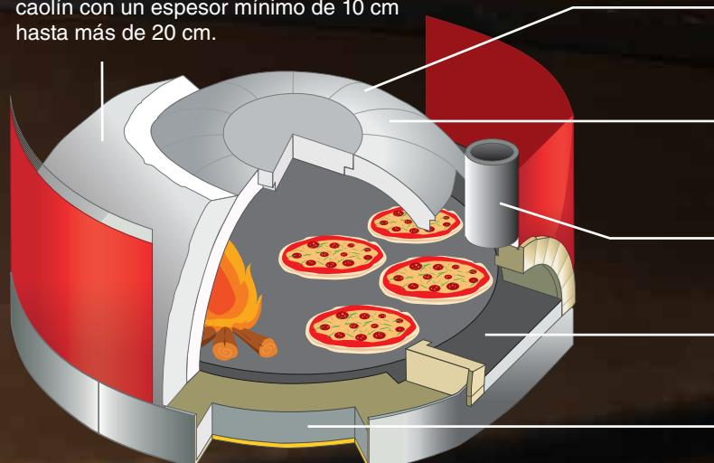
Estucado de unión entre los gajos de la bóveda, y la superficie de cocción y los gajos, en cemento plástico refractario de alta estanqueidad.
